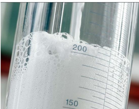
**Lipoo Druckentspannungsflotation.** Das beeindruckend effiziente Verfahren ist ein 3-stufiger Prozess, bei dem das Fettwasser direkt in den Tank geleitet und ohne Flockungsmittel behandelt wird. Die neu integrierte Druckentspannungsflotation entfernt die Schwebestoffe und isoliert sie auf der Fettschicht des Haupttanks, bis sie entsorgt werden. Das behandelte Wasser wird in das Abwassersystem geleitet.
